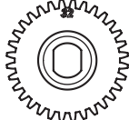
OT221 x1 Final Pinion Gear 32T ファイナルスピニオンギヤ
