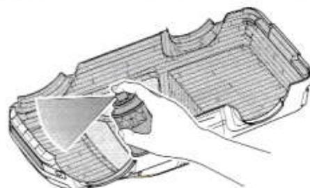
② ★ボディを内側からPS-5(ブラック)で塗装します。スプレー塗装はボディから30cmほどはなし、一度に塗らず数回に分けて塗ります。ブラックが乾いたらウインドウ以外のマスキングテープをはがし、ボディ全体をPS-12(シルバー)で塗装します。
