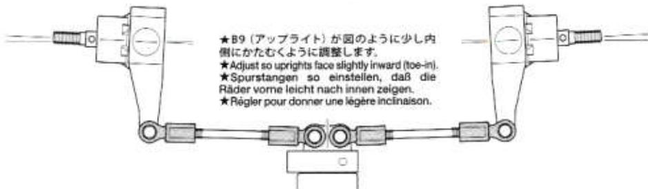
★B9 (アップライト) が図のように少し内側にかたむくように調整します。
