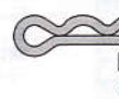
MB7×4 スナップピン(小) Snap pin (small) Federstift (klein) Epingle métallique (petite)
