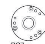
BG7 ×2 デフケースB Diff. case B Diff.-Gehäuse B Carter de différentiel B
