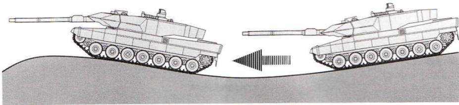
■車体の傾斜を感知する高精度センサーを内蔵。走行中に車体が上下しても、任意の位置で砲身角度を常に一定に保つことができるユニットです。この機能は現用戦車には欠かせないシステムの一つで、あらゆる走行条件下での的確に敵をとらえて正確な射撃を可能にします。砲身スタビライザーユニットを搭載することで、RCタンクにいっそうのリアリティをプラスすることが可能です。
