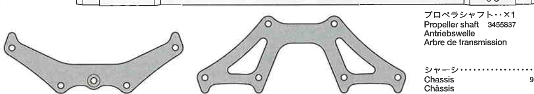
リアブレイス・・・×1 Rear brace 4304070 Hintere Verbindungsbrücke Plaquette supérieure arrière
