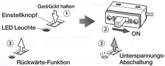
● **Überprüfung der Einstellungen** : Die Einstellungen können über LED-Aufleuchten überprüft werden, wenn der Empfänger eingeschaltet wird. Beachten Sie untenstehendes Schaubild.
