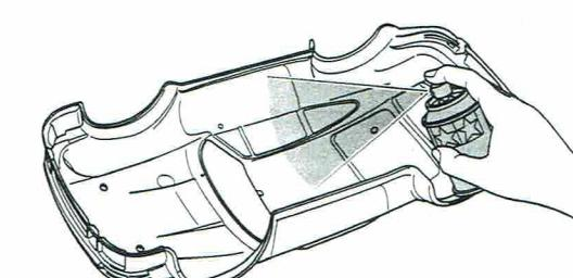
③ ★塗装が乾いたらマスクシールをはがします。塗装終了後にボディ表面の保護フィルムをはがしてください。
